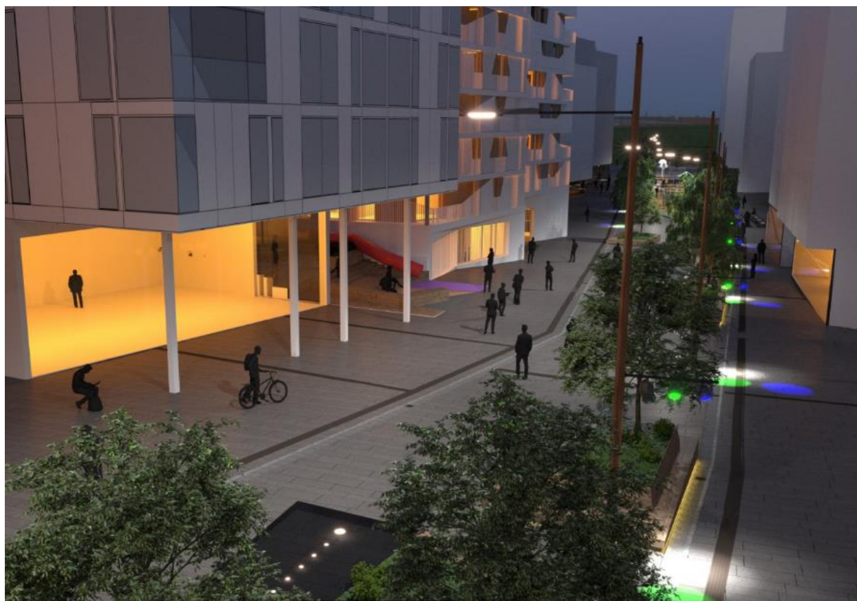
FIGUR 48. Eksempel på lysmaster med utliggerarm, Stylo armatur eller tilsvarende, samt gobokastere. Illustrasjon, COWI AS for Strøktorget i Lillestrøm.
