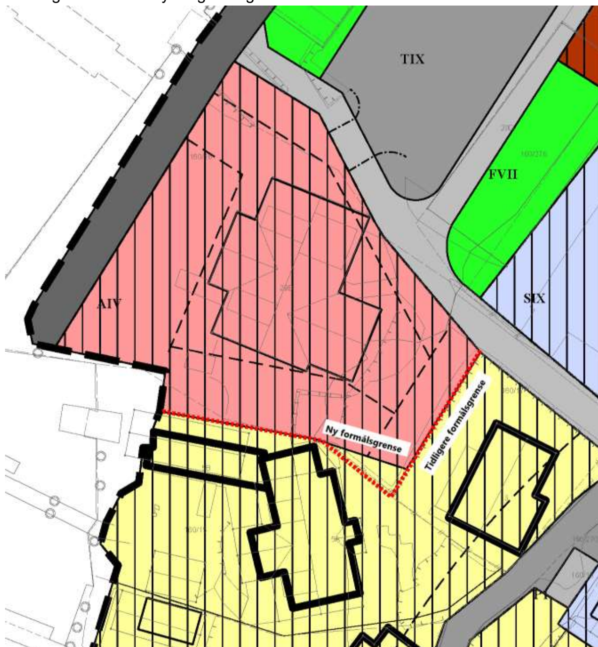
Utsnitt av reguleringsplan med endret formålsgrense mellom område for tjenesteyting (rødt) og boligområde (gult)
