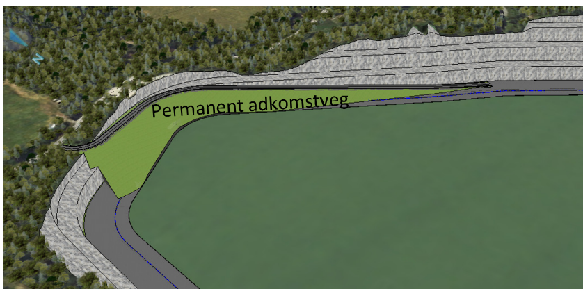
Figur 6. Permanent adkomstveg etter uttak etappe 3
